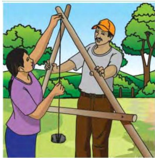
4. Calibración del nivel A. La calibración consiste en encontrar un punto a nivel en el palo transversal, para que cuando el cordón que sujeta la plomada lo intercepte. El nivel tendrá sus dos patas al mismo nivel.
