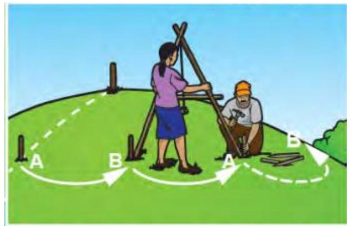
3. Siga girando el Nivel A en la misma dirección, y coloque más estacas en los nuevos puntos de plomada, hasta llegar al extremo de la parcela.
