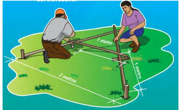
3. En el clavo que une los dos palos amarre una cuerda delgada de 1,20 metros. En la otra punta de la cuerda amarre una piedra (plomada), para que cuelgue a 30 centímetros de distancia del travesaño.
