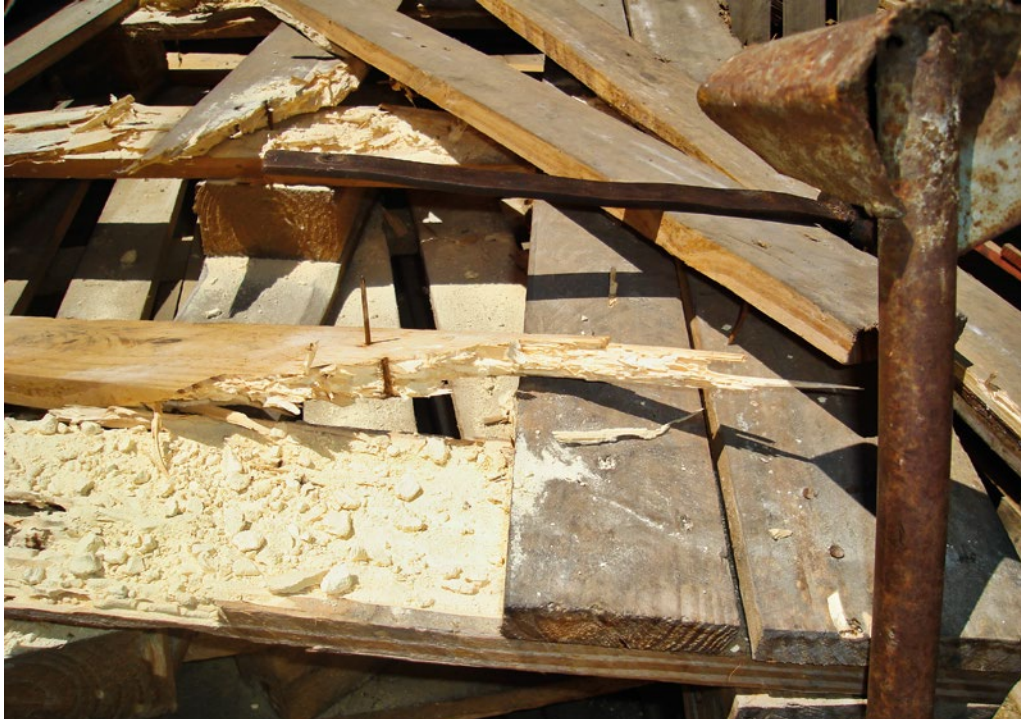
FIGURA 8. Tarima con galerías de Hylotrupes bajulus (SAG, 2008).
