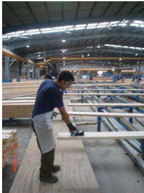
FIGURA N° 2. Medición de la pieza de madera en voladizo.
