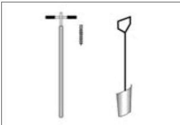
**Figura N°15. Sondeo Manual: Barreno (izquierda) y Pala (Derecha).**
