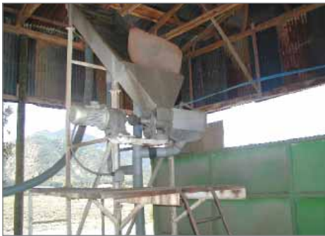
Figura 8. Separador de harnero inclinado estacionario con filtro prensa tornillo en el extremo.
