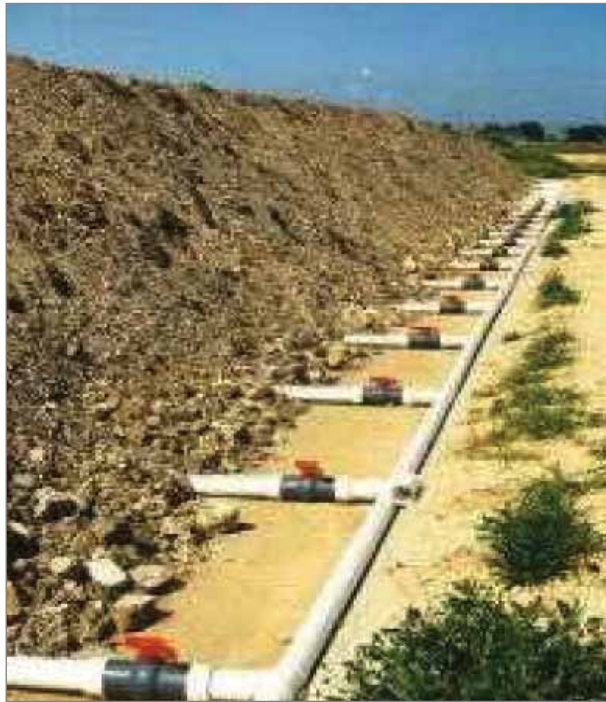
Figura 38. Método de compostaje con pilas estáticas (static pile)
