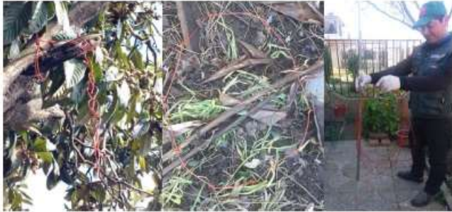
Figura 2. Instalación de emisores en grupo de 10, formando un rosario o una argolla.
